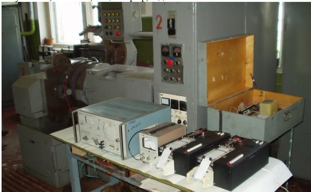
Рис 1 – Експериментальний стенд на базі двох стороннього торцево шліфувального верстату моделі 3342 АДО
