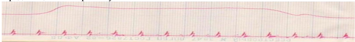
Рис. 2 – Потужність шліфування у функції кута повороту барабану подачі (часу)
