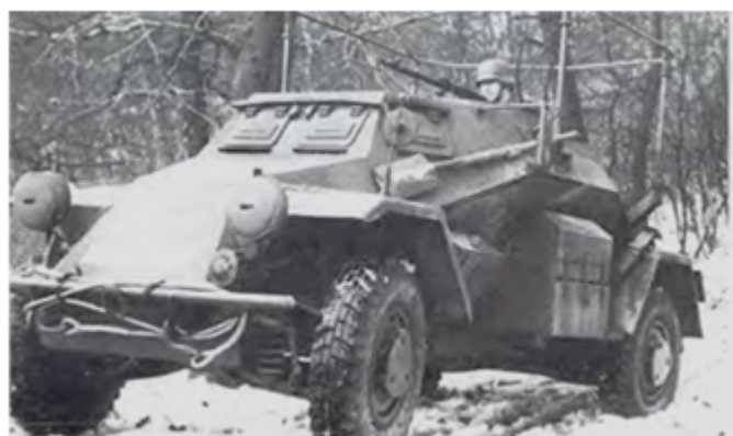
Рис. 4. Армійська розвідувальна бронемашина Sd.Kfz.263 (а) та легкий броньований автомобіль Sd.Kfz. 221 (Хорьх-801) – розвідка германських танкових колон (б)
