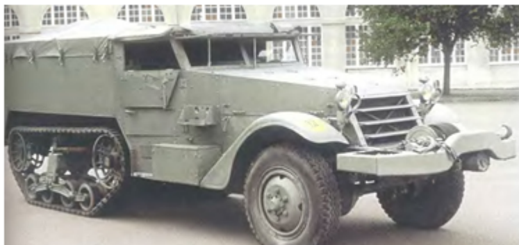
Рис. 2. Напівгусеничний бронетранспортер М3 (США, 1942)
