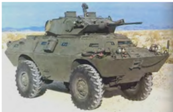
Рис. 7. Броневий автомобіль «Коммандо» V150
