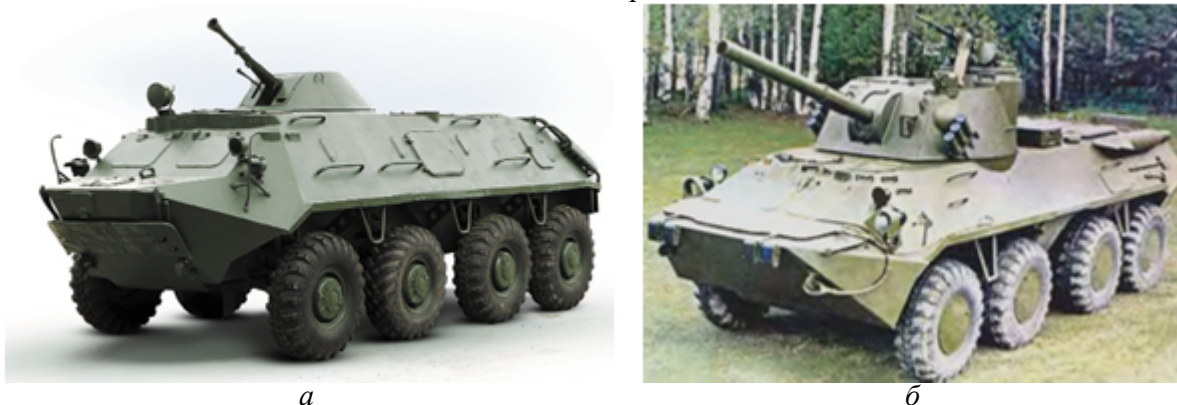
Рис. 6. Бронетранспортер БТР-60ПБ (1961) (а) та 120-мм самохідна артилерійська гармата Нона-СВК на шасі БТР-80 (1987)
