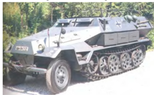
Рис. 1. Напівгусеничний бронетранспортер «Ганомаг» (Германія, 1940)
