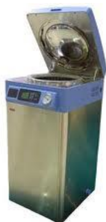
Рисунок 1.2 – Стерилізатори парові (автоклави)
