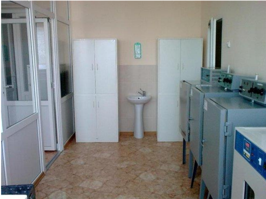
Рисунок 1.5 – Передбокник (оснащений термостатами на різну температуру, шафами для середовищ і стерильного одягу для роботи в боксі, стаціонарними бактерицидними лампами – стельовими та настінними).
