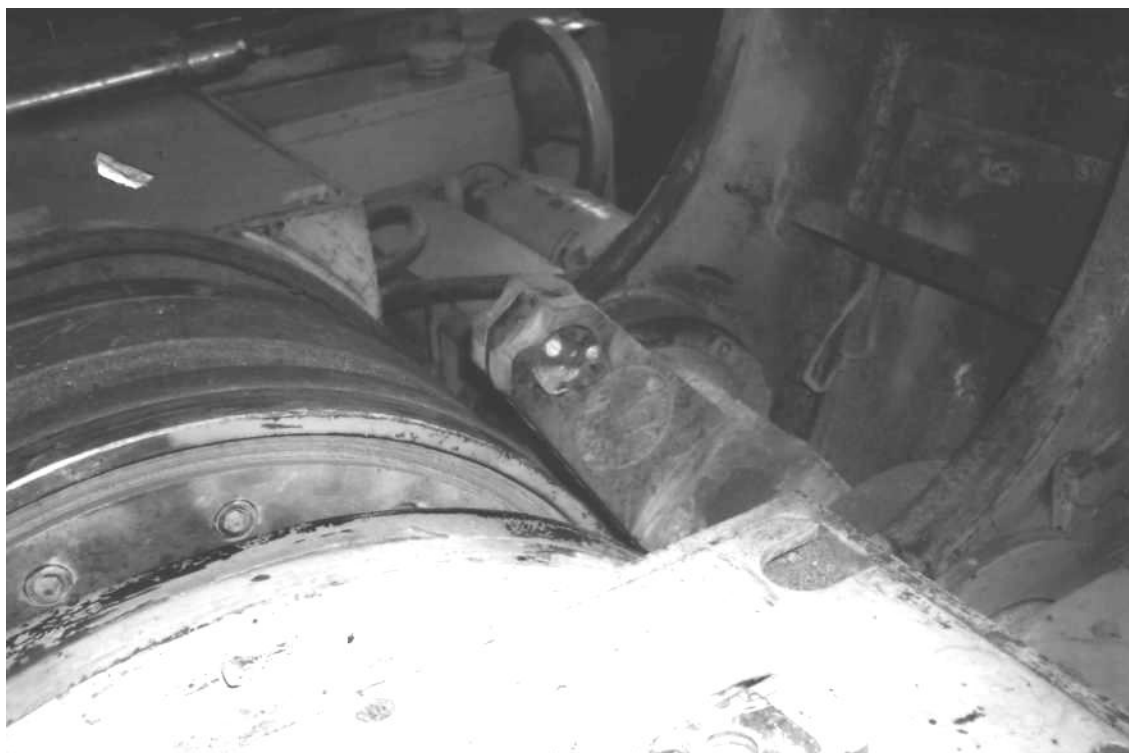
Рис. 6.1.5. Правка с помощью специального устройства в плоскости, перпендикулярной оси вращения круга
