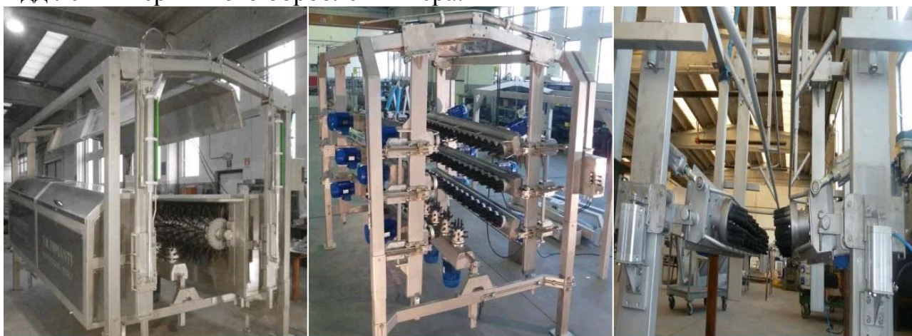
а – ротодискова бильна машина; установка для доощипування; установка для зняття пір'я на колінних суглобах
