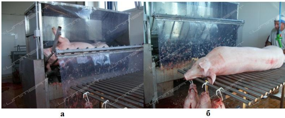
Рисунок 1.15 – Зняття щетини: а – у скребмашинах; б – ручне видалення залишків щетини на приймальному столі
