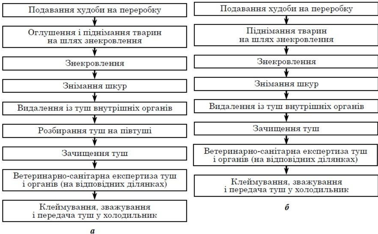
Рисунок 1.2 – Технологічна схема переробки тварин:
