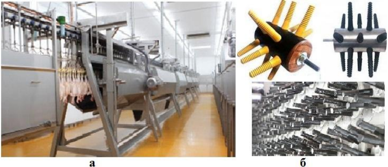
Рисунок 2.8 – Бильна машина (а) і пальці бильної машини (б)
