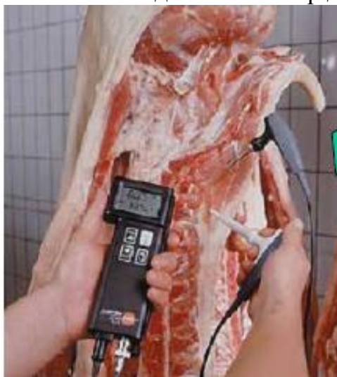
Рисунок 1.28 – Виміри показників м'яса за допомогою портативного рН-метра
