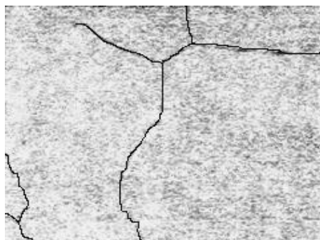
Рисунок 7.9 – Структура чистого не травленого свинцю, відлитого на скло, \times 400
