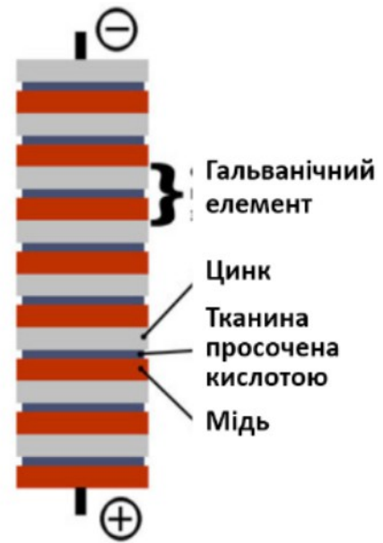
Рис. 8. Схема вольтового стовпа
