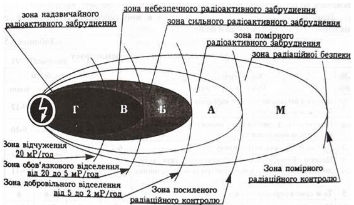
Рисунок 3.2 Схематичне зображення зон радіоактивного забруднення
