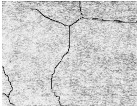
Рисунок 3.16 – Структура чистого не травленого свинцю, відлитого на скло, \times 400
