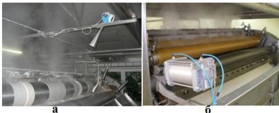
Вальцьова сушарка: а - без сировини; б - з клейстеризованим крохмалем
