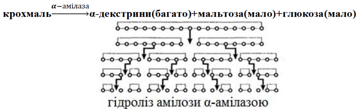
Рисунок 6.22 – Гідроліз крохмалю під дією \alpha -амілази
