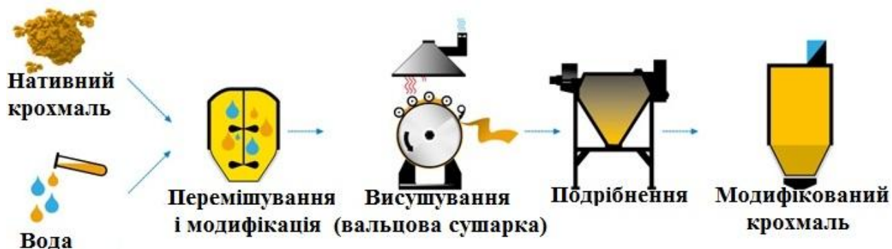
Рисунок – 6.25 – Схема одержання набухаючих крохмалів
