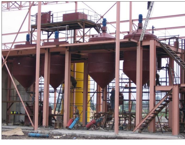
Рисунок 5.16 Зовнішній вигляд та схематичне зображення гідрататора-нейтралізатора
