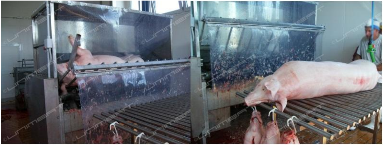
Рисунок 2.15 – Зняття щетини: а – у скребмашинах; б – ручне видалення залишків щетини на приймальному столі
