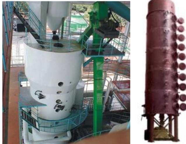
Рисунок 5.13 – Чанний випарник (тостер) для відгону розчинника із шроту
