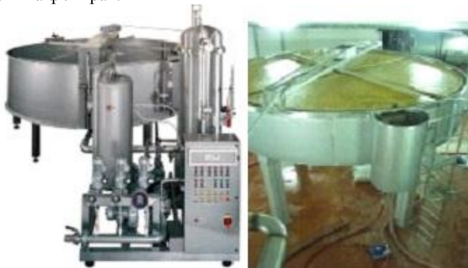
Рисунок 6.15 – Флотаційні установки для оклеювання сусла
