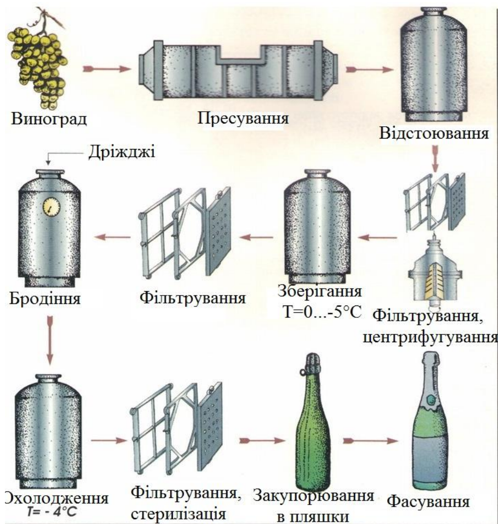
Рисунок 6.26 – Схема резервуарної шампанізації
