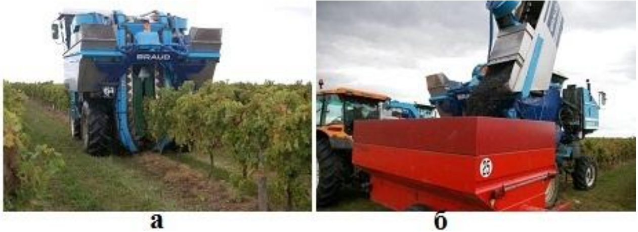
а – збиральна машина зриває ягоди з лоз; б – вивантаження ягід у колектор для транспортування на виноробню
