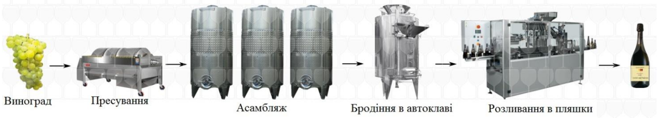
Рисунок 6.19 – Схема резервуарного методу шампанізації вин
