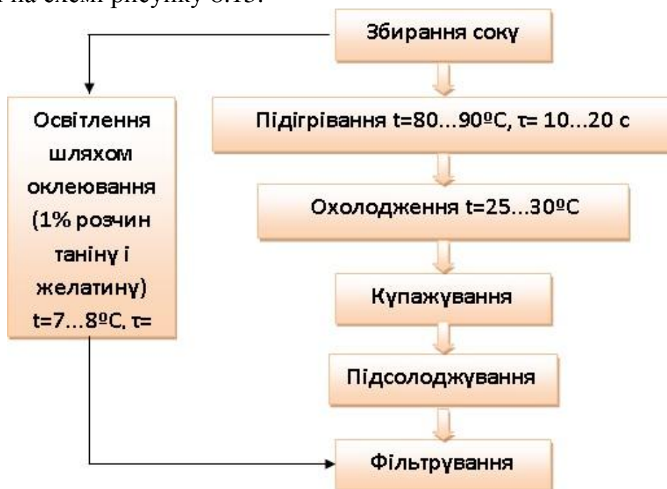
Рисунок 8.15 – Етапи виробництва соків після їх вилучення із сировини
