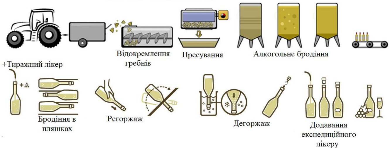
Рисунок 6.18 – Схема класичного методу шампанізації вин
