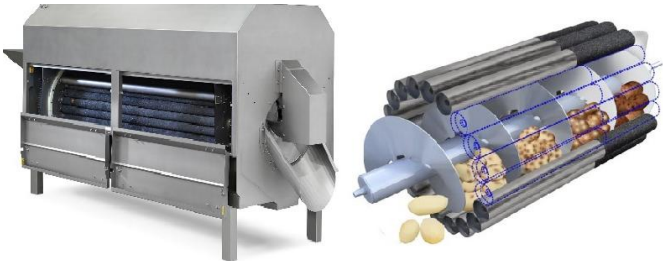
Рисунок 7.17 – Машина для очищення за допомогою абразивних матеріалів
