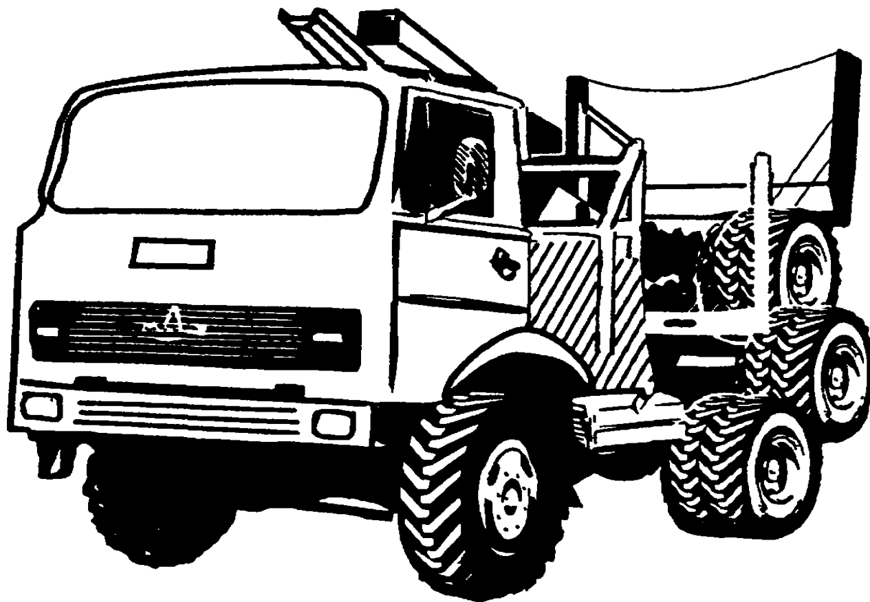
Рисунок 5.5 – Транспортування порожнього причепа-розпуску на автомобілі-тягачі
