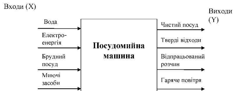
Рис. 2.2. Модель чорної скрині на прикладі системи „Посудомийна машина
