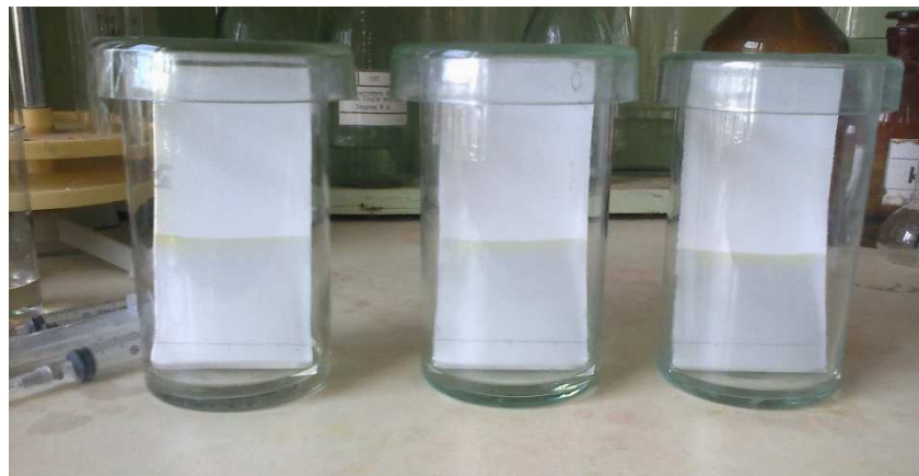
Рис. 3. Проведення дослідження у камерах для хроматографії
