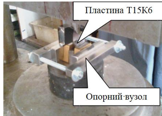
Рис. 2 – Тестування на згин змінної різальної пластини з Т15К6
