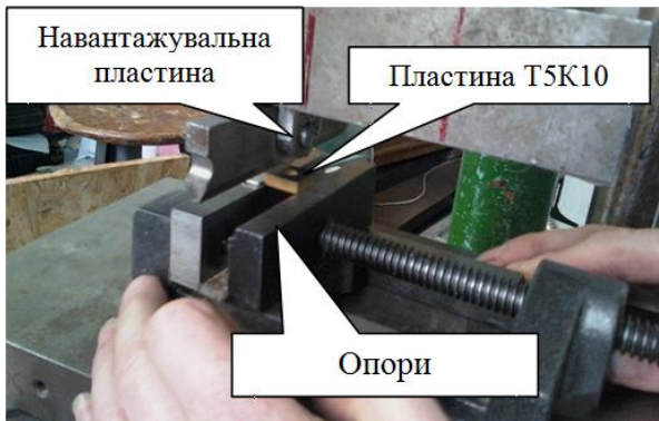
Рис. 1 – Тестування на згин змінної різальної пластини з Т5К10
