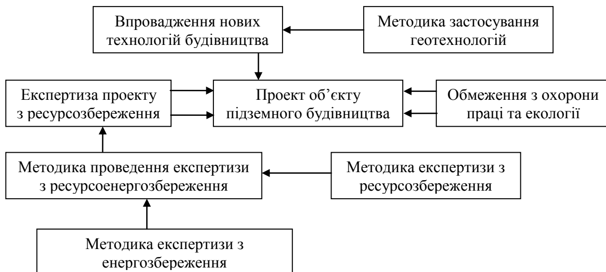
Рис. 1 – Структурна схема ресурсоенергозбереження під час проектування об'єктів підземного будівництва
