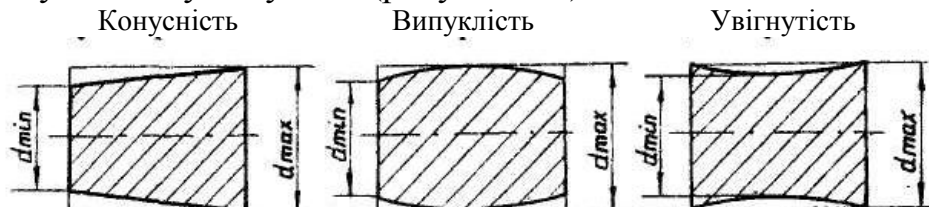
Рисунок 1.9– Окремі випадки відхилення профілю поздовжнього перетину
