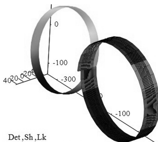
Рис. 4. Математична 3D модель шліфувального круга, деталі та їх лінії контакту
