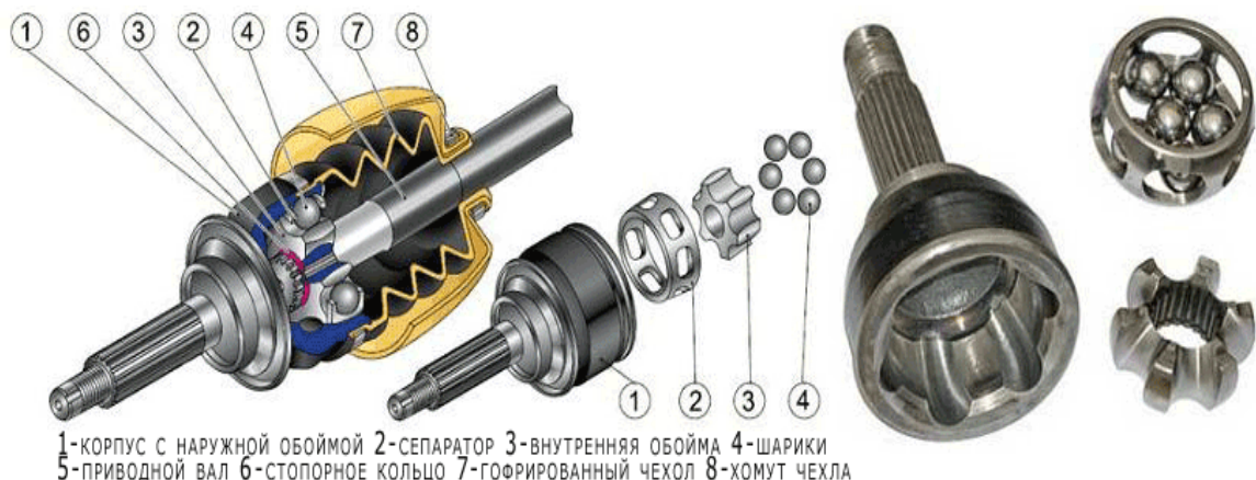
Рисунок 11.1 – Карданна передача з шарнірами нерівних кутових швидкостей
