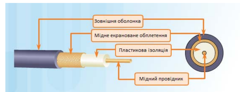
Рис.20. Структура коаксіального кабелю
