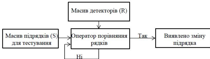
Рис. 3.3. Контроль даних з використанням масиву детекторів
