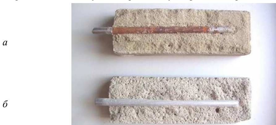
Рис. 5. Дослідження антикорозійних властивостей інгібіторної суміші: а – без просочення; б – з просоченням МІК
