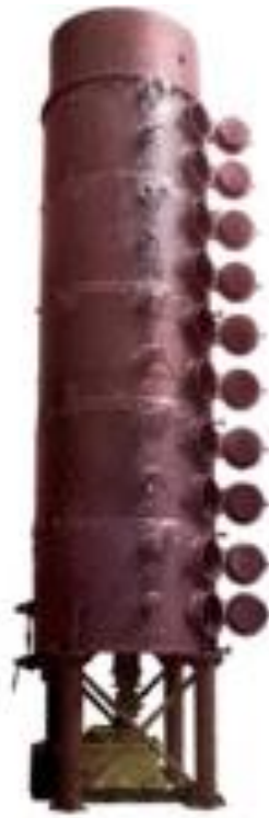
Рисунок 2.13 – Чанний випарник (тостер) для відгону розчинника із шроту
