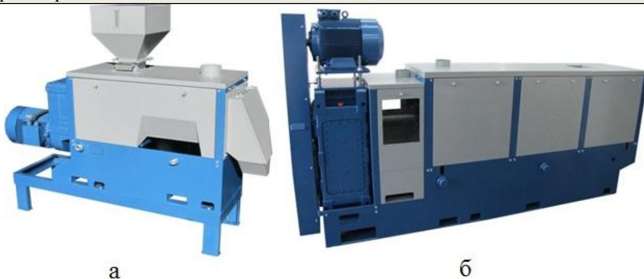
а – форпреси; б – експелерні преси;
