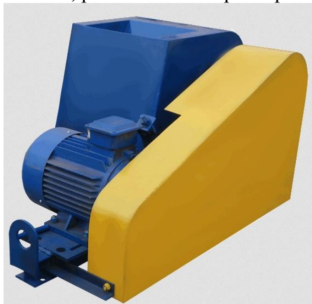
Рисунок 2.6 – Верстат вальцьовий для подрібнення насіння
