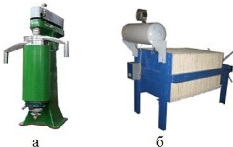
а – високошвидкісна трубчаста центрифуга для розділення двох рідин, що не змішуються між собою; б – рамний фільтр-прес
