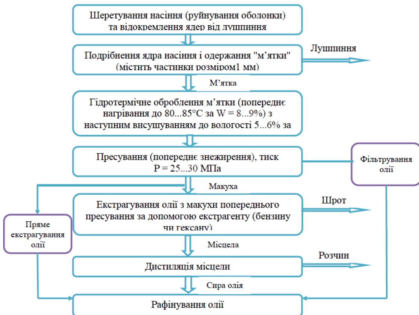
Рисунок 2.4 – Типова технологічна схема одержання олії (за виключенням етапу очищення і зберігання насіння)
