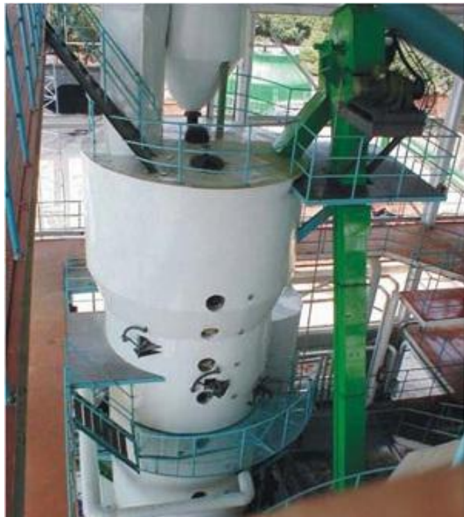
Рисунок 2.13 – Чанний випарник (тостер) для відгону розчинника із шроту
