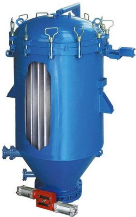
Рисунок 2.17 – Вертикальний листовий напірний фільтр
