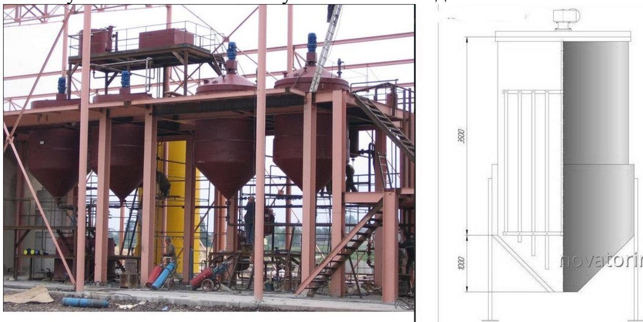
Рисунок 2.16 Зовнішній вигляд та схематичне зображення гідрататора-нейтралізатора
