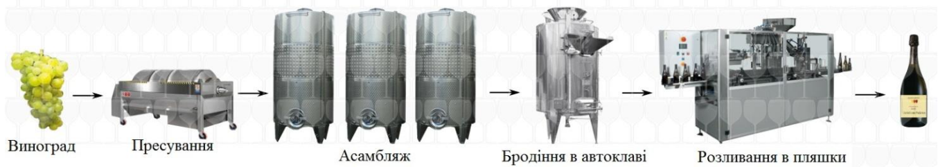
Рисунок 1.19 – Схема резервуарного методу шампанізації вин
