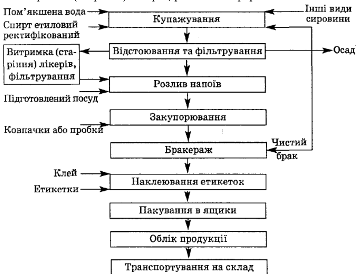
Рисунок 7.2 – Принципово-технологічна схема виробництва лікєро-горілочаних напоїв
