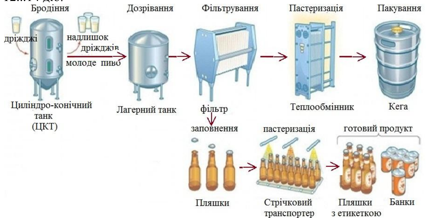
Рисунок 3.2 – Технологічна схема виробництва пива із сусла
