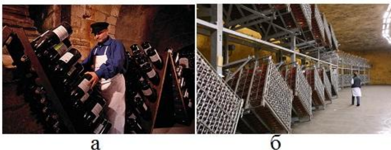
Рисунок 1.23 – Зведення осаду на пробку пляшки
