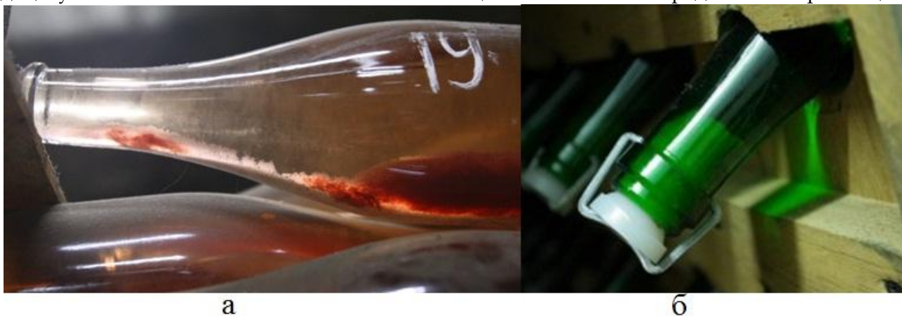
Рисунок 1.23 – Зведення осаду на пробку пляшки
