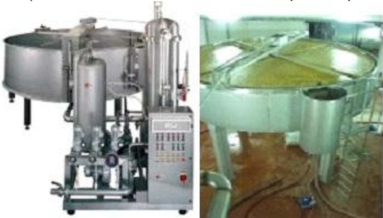
Рисунок 1.15 – Флотаційні установки для оклеювання сусла
