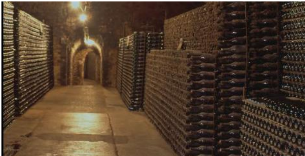
Рисунок 1.22 – Укладання пляшок з тиражною сумішшю
