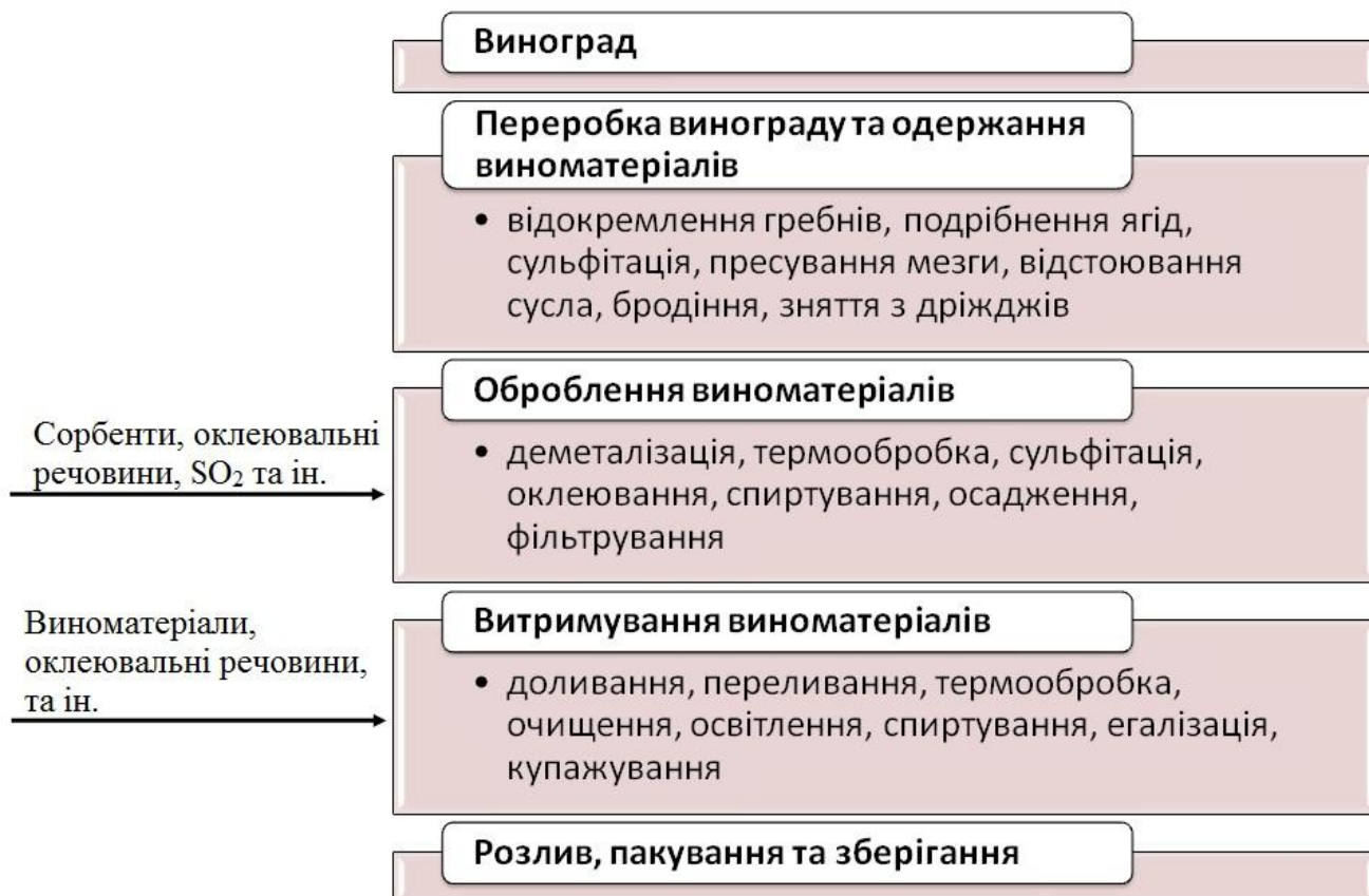
Рисунок 1.6 – Типова блок-схема одержання столових тихих вин
