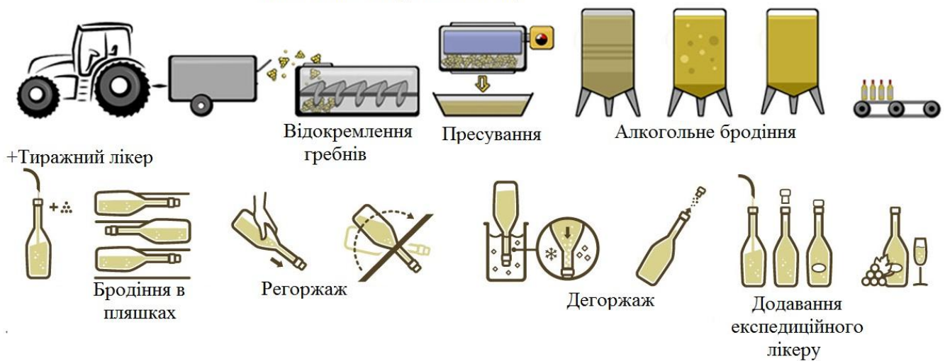
Рисунок 1.18 – Схема класичного методу шампанізації вин
