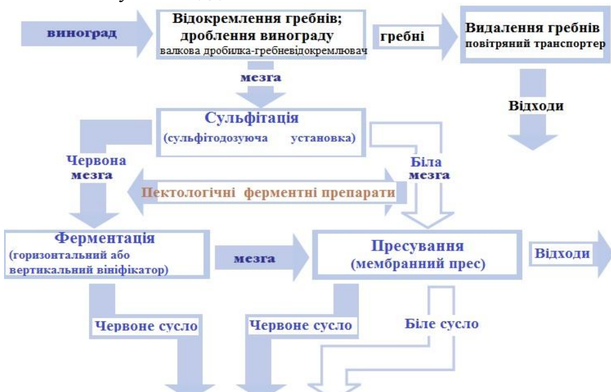
Рисунок 1.8 – Відмінність переробки винограду у вино для білих і червоних вин
