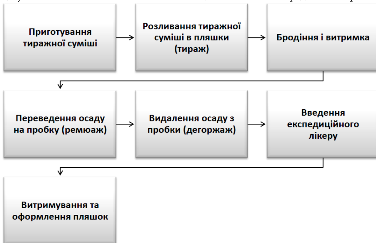
Рисунок 1.20 – Етапи виробництва ігристих вин
