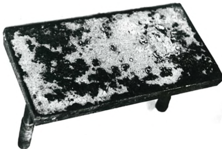
Рис. 3. Штамп для пресування шамотних виробів із шарженою поверхнею
