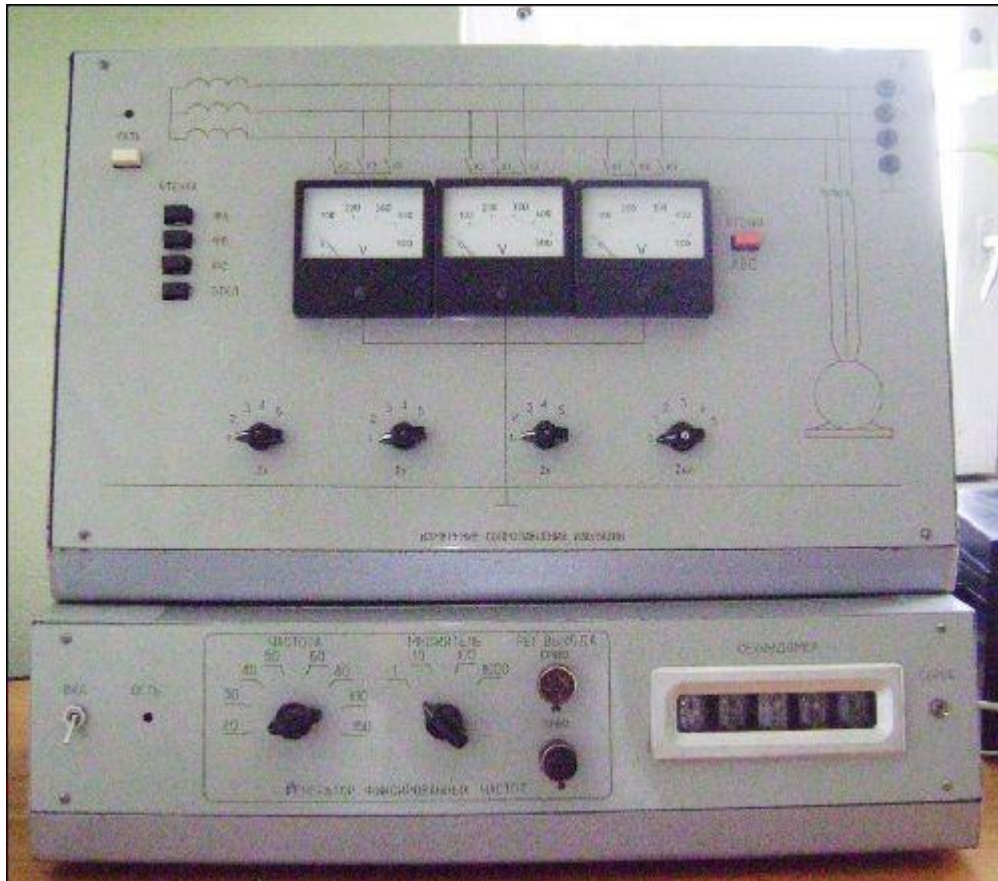
Рисунок 8.2 – Стенд для контролю ізоляції методом трьох вольтметрів
