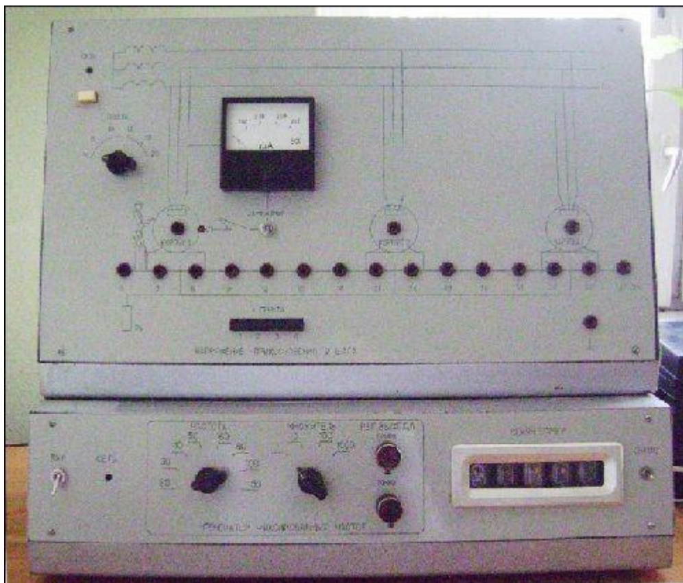
Рисунок 5.2 – Стенд для визначення напруги дотику та кроку
