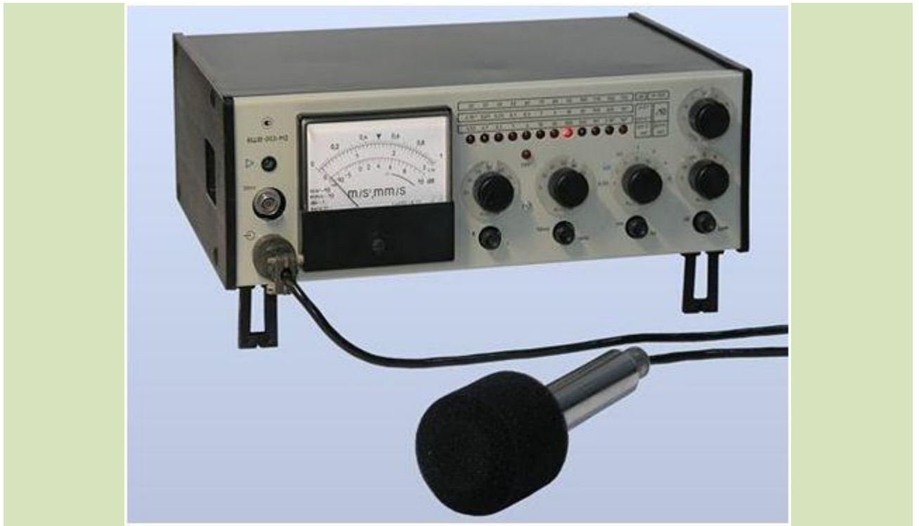
Рисунок 2.1 – Прилад для вимірювання шуму та вібрації ВШВ-1
