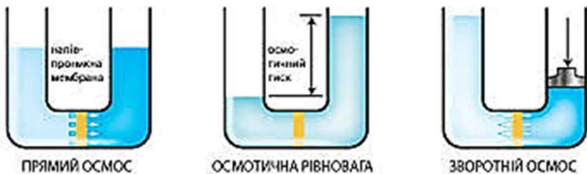
Рисунок 15. Принцип роботи зворотного осмосу
