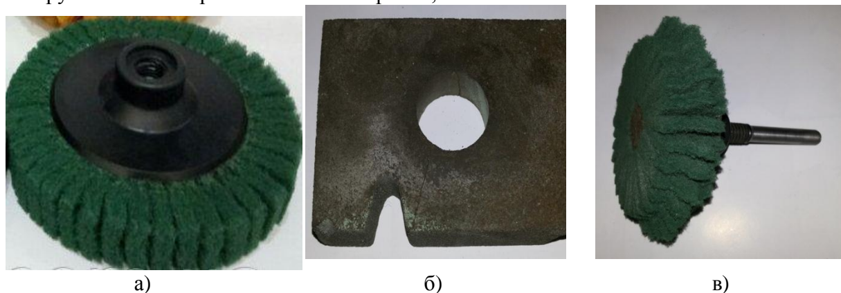
Рис. 1 – Круг КЛ125x30xM14-P240 (а), вид правящей абразивной рейки (б) и инструмента после правки (в)
