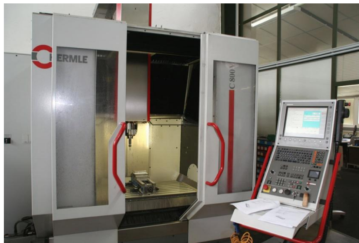
Рис.3 – Загальний вигляд 3-осового центра HERMLE C800 V з ЧПК
