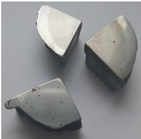
Рис. 1 – Зразки для вимірювання твердості і вивчення мікроструктури
