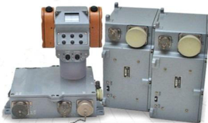
Рис. 1 – Комплекс цифрового стабілізатора озброєння СВУ-500-10Р
