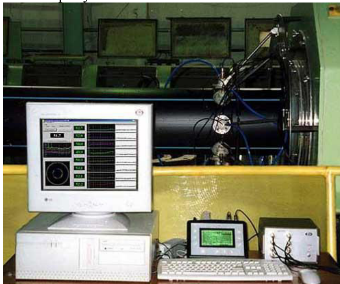
Рис. 1 – Зовнішній вигляд 8-канальної системи ультразвукової дефектоскопії і контролю якості
