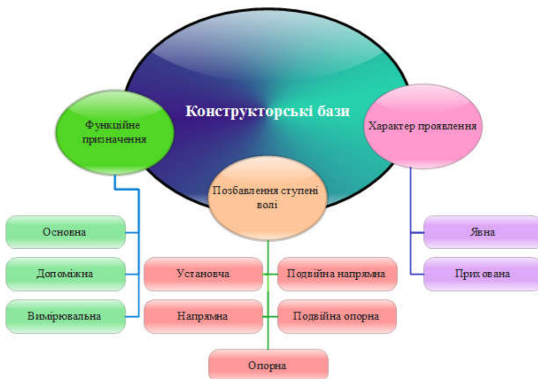
Рис. 5.14. Види конструкторських баз
