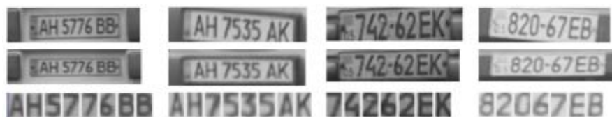
Рис. 2. Приклади роботи алгоритмів нормалізації зображення номера і сегментації символів
