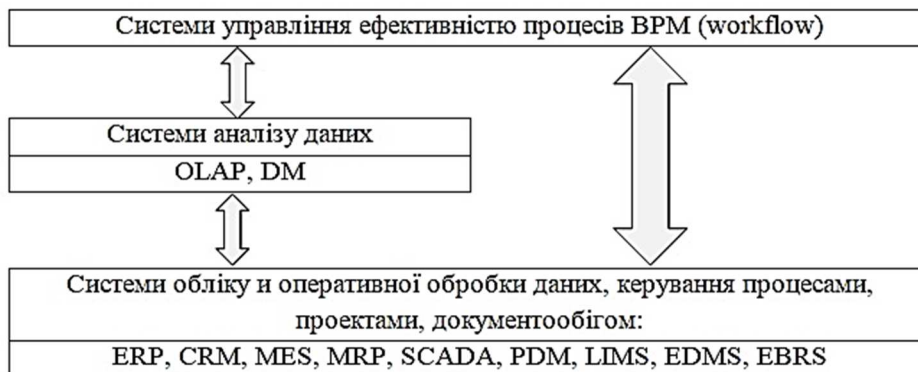
Рис. 3. Структура взаємодії компонентів інформаційно-керуючої СУЯ
