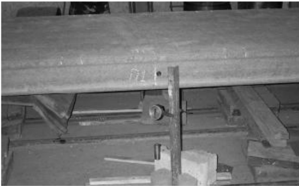
Рисунок 1.2. Прогиномір ПМ-3 в перерізі L/2 залізобетонної плити.
