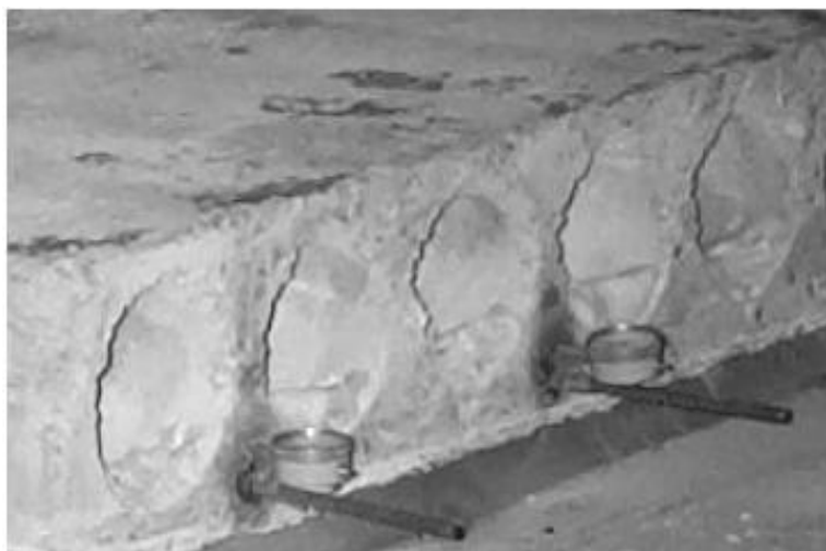
Рисунок 1.9. Фрагмент підготовки залізобетонної плити до статичних випробувань: установка індикатора годинникового типу ІГ-10 в торці плити для визначення можливого просмикування арматури по бетону.
