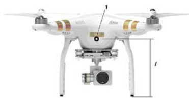
Рис. 2. Квадрокоптер Phantom-3 з візирними марками
