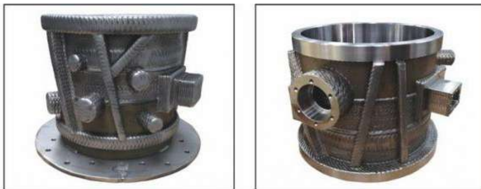
Рисунок 2 – Заготовка після 3D-друку та готовий корпус редуктора (виготовлено на обладнанні Gefertec arc405) [2]
