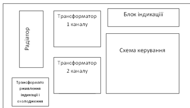
Рисунок 4 – Розташування плат в блоці живлення
