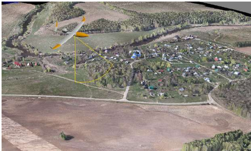
Рисунок 2 - Виконання зйомки місцевості з використанням БПЛА
