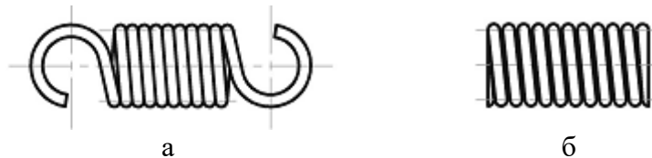
Рисунок 2 – Пружини в стані спокою: а) розтягу; б) стиску
