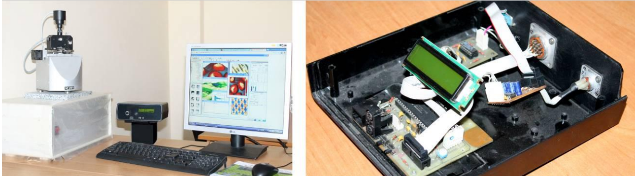
Рис.1 – Зовнішній вигляд комплексу нанометричного контролю із запровадженою автоматизованою системою контролю (зліва) та схематичне наповнення блоку контролю (справа)
