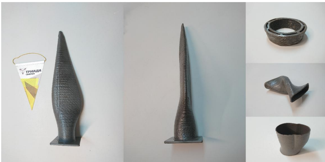
Рис. 1 – Вироби виготовлені за технологією адитивного виробництва способами СМТ та МІГ зварювання Виявлено ряд недоліків технологічного процесу:
