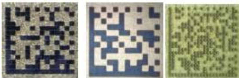
а) чорне-відпалене маркування б) чорне маркування в) гравірування на основі маркування
