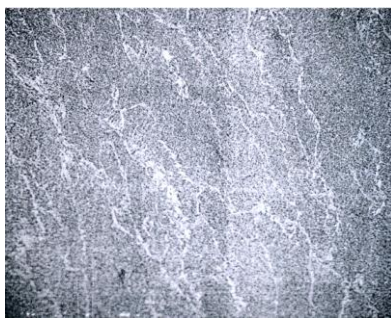
Рис. 3 – Мікроструктура металу наплавленого валика: а) – без перемішування металу зварювальної ванни; б) – з перемішуванням, \times 200 ; (режим наплавлення: I_H = 210 \dots 240 \text{ A} , U_d = 26 \text{ V} )
