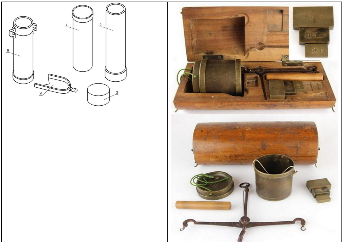
Рис. 4.1 – Конструкція пурки: 1 – мірний циліндр, 2 – накопичувальний циліндр, 3 – циліндр з випускною лійкою, 4- ніж , 5 – зібрана пурка, 6 – вантаж.
