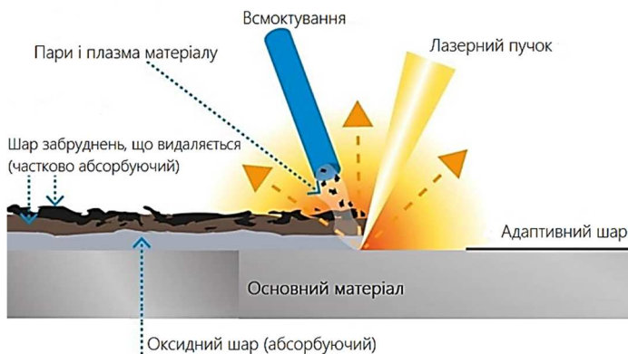
Рис. 1. Принцип дії обладнання безконтактної лазерної дезактивації
