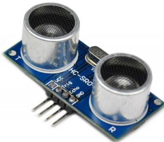
Рис. 1 Датчик відстані HC-SRO4
