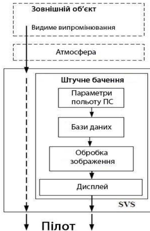
Рис.2 Структурна схема SVS
