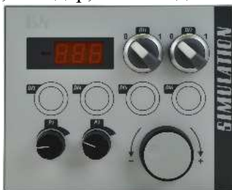
Рис. 2 – Імітатор операторської панелі 4SIM.10-01
