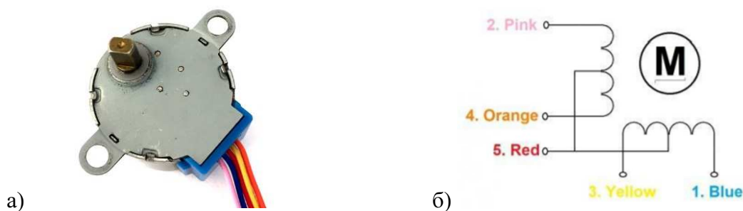
Рис. 1 – Кроковий двигун 28BYJ-48-12V: а) загальний вигляд; б) схема комутації фаз двигуна.
