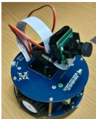
Рис. 1 – Зібрана роботизована платформа «AlphaBot 2»
