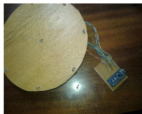
Рис. 2 - Зовнішній вигляд цифрового люксметра
