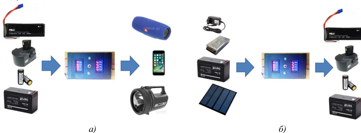
Рис. 2 – Підключення батареї до блоку живлення в режимі розряджання (а) та заряджання (б)
