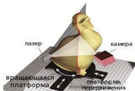
Рис. 3 – Побудова триангуляційного тривимірного сканера
