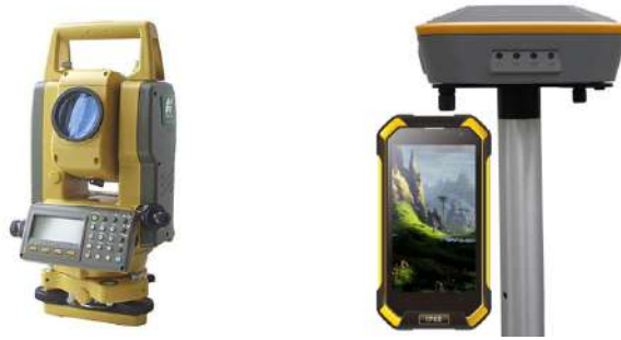
Рисунок 1 - Електронний тахеометр Topcon GTS-105n та GPS- приймач South p660
