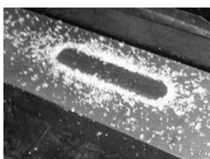
Рис. 1 – Продукти зношування чистого політетрафторетилену (а) та композиту (б)
