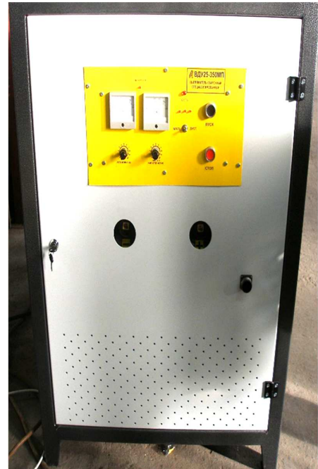
Рис. 2 – Джерело зварювального струму для роботи з віддаленими об'єктами
