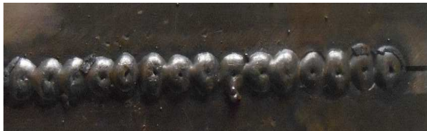
Рис. 4 – Стиконе з'єднання, виконане зі звичайною подачею електродного дроту способом отримання точок.
