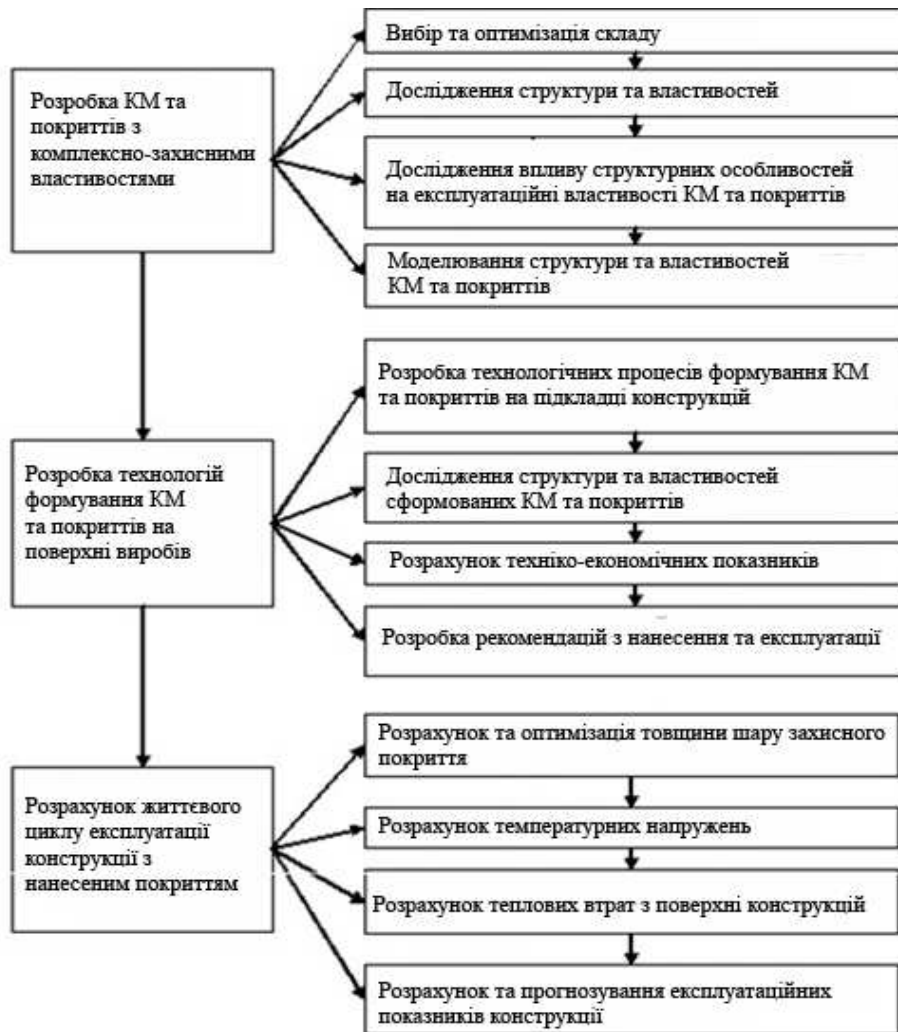
Рис.1 – Алгоритм вирішення технологічного завдання підвищення захисту елементів суден для радіоактивних вантажів
