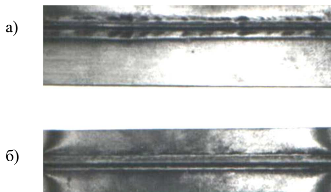
Рис. 4 – Зразки наплавлення: а – без застосування системи регулювання шпаруватості; б – із застосування системи регулювання шпаруватості
