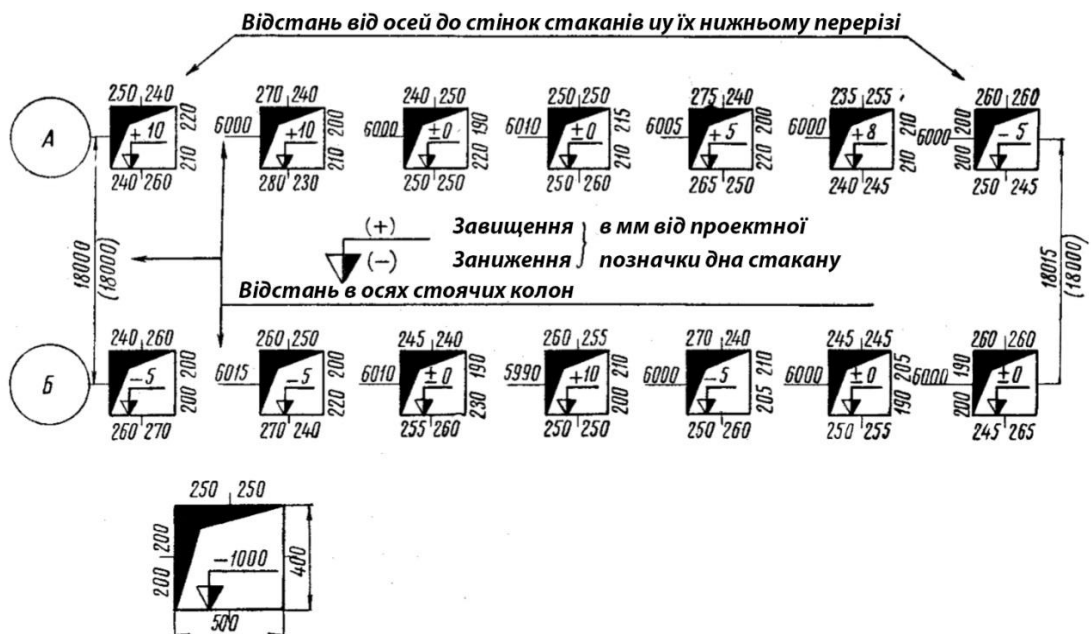
Рисунок 5.5. Виконавча схема планово-висотного положення стаканів фундаментів під залізобетонні колони
