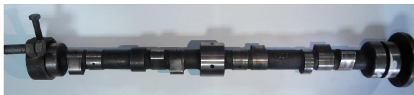
Рис. 5. Оброблювальні деталі: вал (а), розподільчий вал (б)
