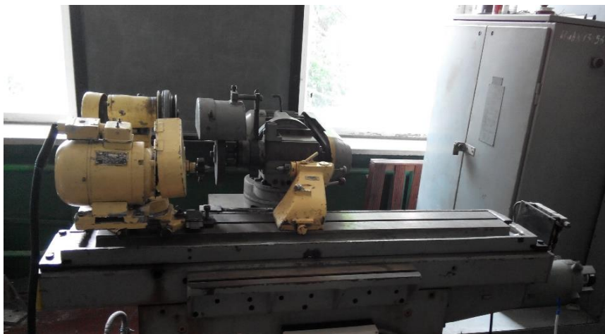
Рис. 2. Загальний вигляд верстата з ЧПК В3208Ф3
