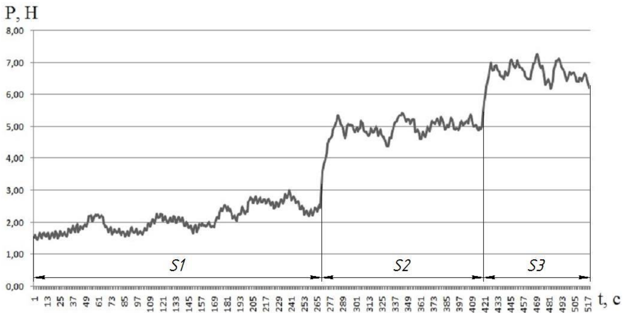
Рисунок 4.4 – Сила різання при шліфуванні циліндричної поверхні периферією орієнтованого круга в режимі затуплення
