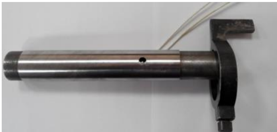
Рисунок 2.3 – Розміщення термопари в середині вала
