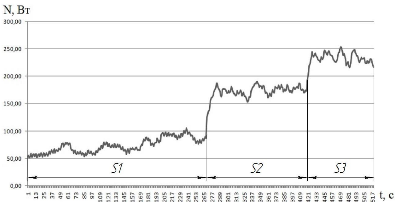
Рисунок 4.3 – Графік активної потужності, що витрачається під час процесу шліфування з паралельними осями деталі та круга
