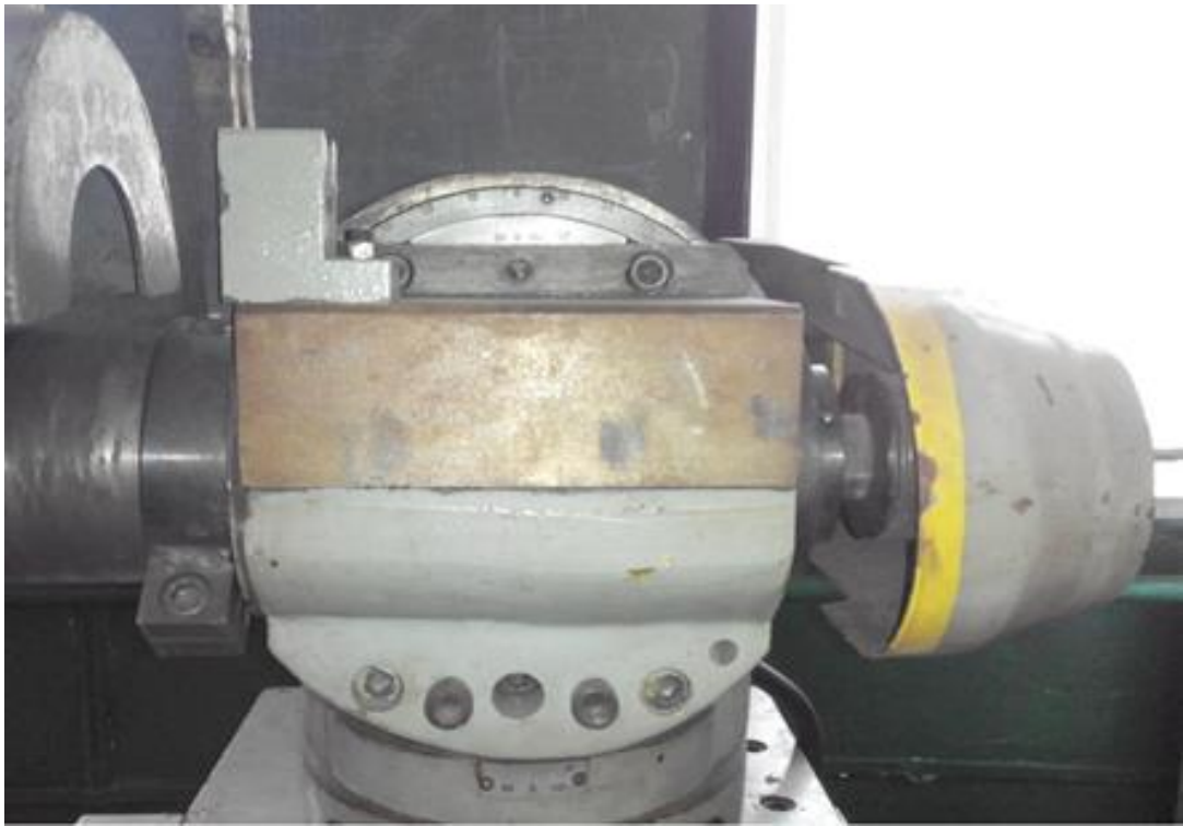
Рисунок 2.12 – Конструкція шліфувальної бабки верстата В3208-ФЗ
