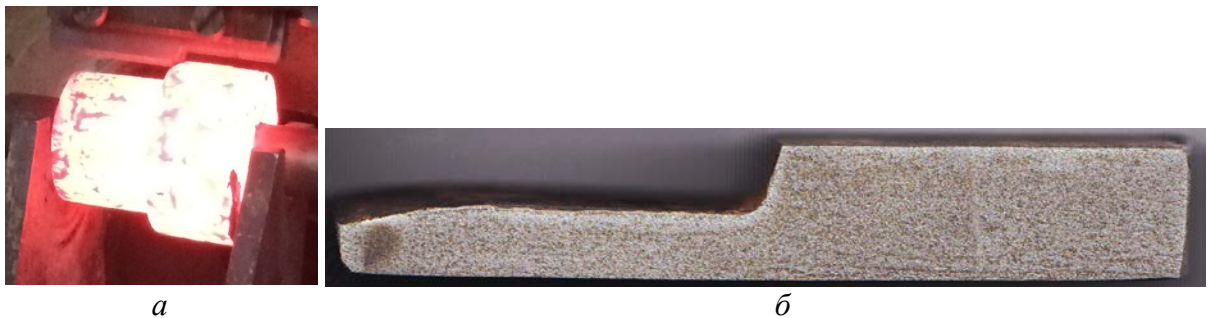
Рис. 2 – Експериментальне дослідження: а – процес розкочування сталевих заготовок у гарячому стані; б – макробудова поковки по перетину
