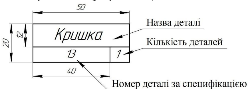
Рисунок 2.15 – Приклад умовного відображення деталі (складальної одиниці) на схемі складання
